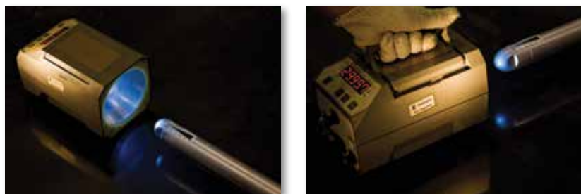
频闪观测仪测量振动棒棒头的振动频率与转速
