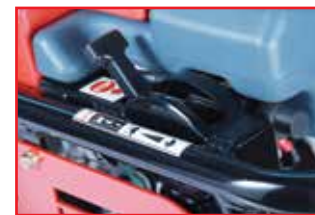
可轻易触及的互锁油门杆、安全开关与燃油切断装置
