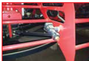
动力阻燃剂喷涂系统
