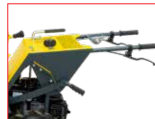
装备离合器控制的手柄，以快捷简易的操作
